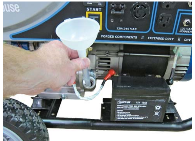
Figura 28 – Procedimiento para agregar el aceite del motor
