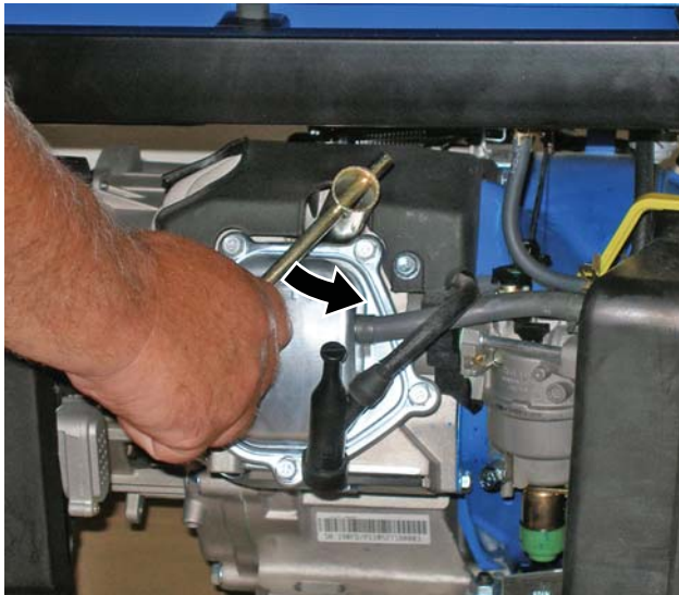
Figura 37 – Procedimiento para extraer la bujía
