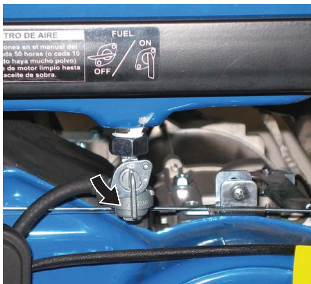
Figura 22 – Válvula de cierre del combustible en la posición ON (encendido)
